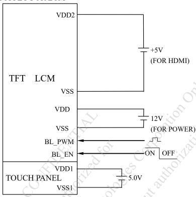
NOTE ( 1 ) : ADJUST THE PWM SIGNAL IN ORDER TO CONTROL LED BACKLIGHT'S BRIGHTNESS. THE HIGHER THE DUTY CYCLE, THE HIGHER THE BRIGHTNESS
